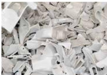
La céramique est le plus ancien matériau malléable utilisé par les hommes, et elle se compose exclusivement de matières premières d'origine naturelle. La céramique est 100 % recyclable et elle peut être réintroduite dans les processus de production sous forme de poudre ou réutilisée comme une matière première précieuse dans d'autres industries.
