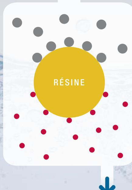
L'eau dure riche en ions de calcium et de magnésium établit une liaison plus forte avec les résines que les ions de sodium. Les ions de sodium ainsi supplantés prennent leur place dans l'eau, et il en résulte de l'eau douce.
